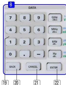
Abb. 5.2: Abschnitt B mit numerischer Tastatur, Einheiten- und Bearbeitungstasten
